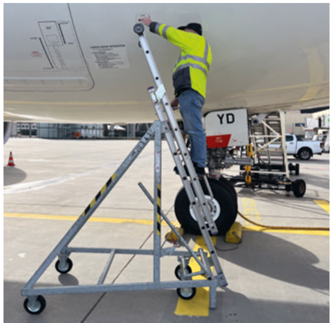
Zum Öffnen der Ladeluken, Anschluss des Bodenstroms und kleine Wartungsarbeiten am Rumpf des Flugzeugs geeignet.
