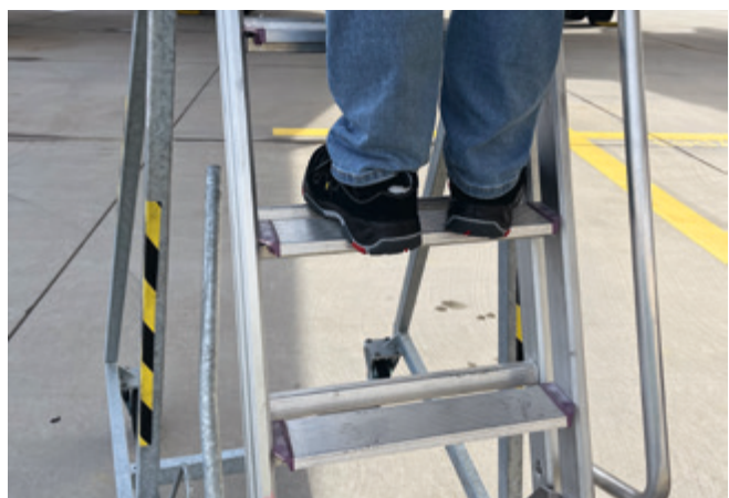
Durch 80 mm breite Stufen ist die Leiter TRBS 2121-2 konform.
