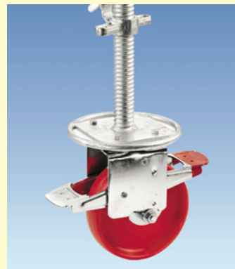
HAGO-Fahrrolle Ø 200 mm (Tragfähigkeit 11,9 kN/1190 kg, höhenverstellbar)
