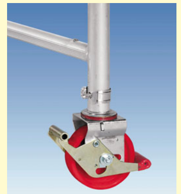
HAGO-Fahrrolle Ø 150 mm (Tragfähigkeit 3,0 kN/300 kg, nicht höhenverstellbar)
