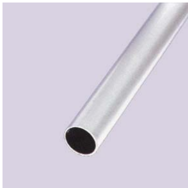
Best.-Nr. 0300 4300 00 Stahlrohr Ø 30x1,5 +0,15 -0,20 mm, feuerverzinkt im Abblasverfahren, in Herstellungslängen von ca. 6 m.
