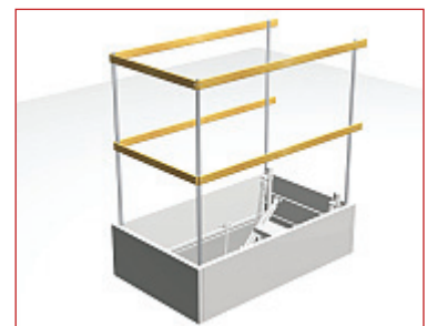
Lukenumwehrung aus Holz mit Stahlstützen (baurechtlich vorgeschrieben)
