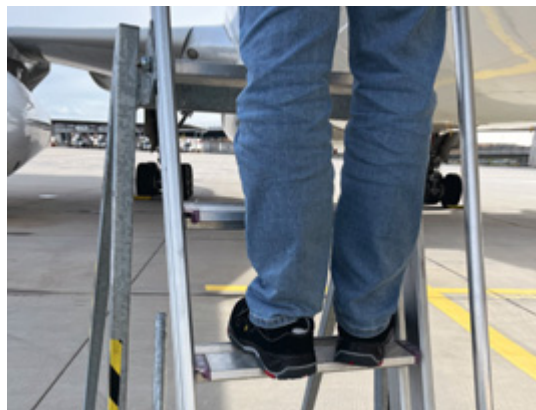
Durch 80 mm breite Stufen ist die Leiter TRBS 2121-2 konform.
