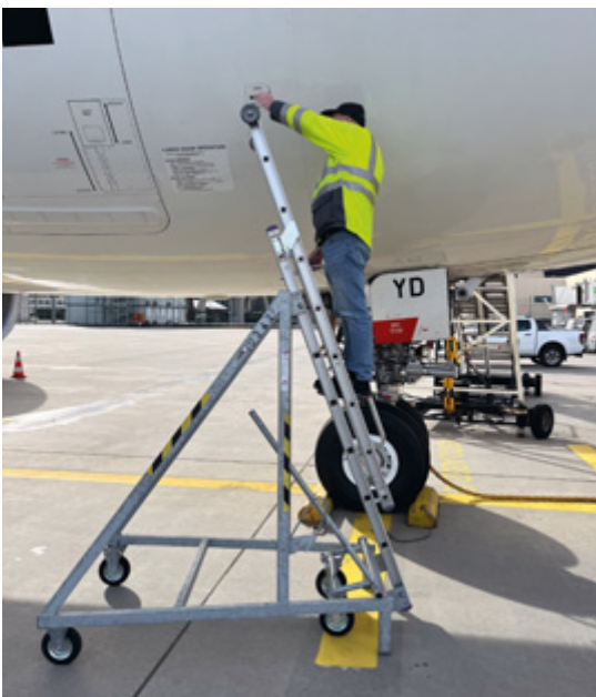
Zum Öffnen der Ladeluken, Anschluss des Bodenstroms und für kleine Wartungsarbeiten am Rumpf des Flugzeugs geeignet.
