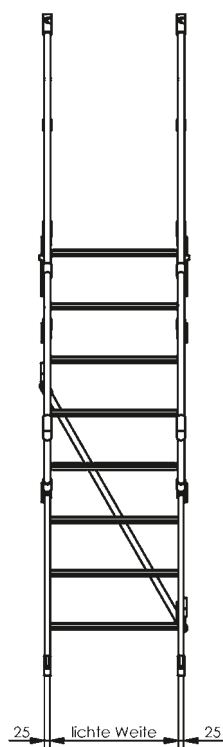
Podesttreppen ohne Stützteil Serie 75L Draufsicht
