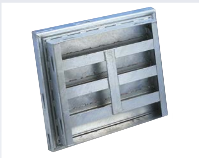
BVS-400 Unterseite mit Zusatzrahmen, IPE-Trägern und Flachstahl verstärkt
